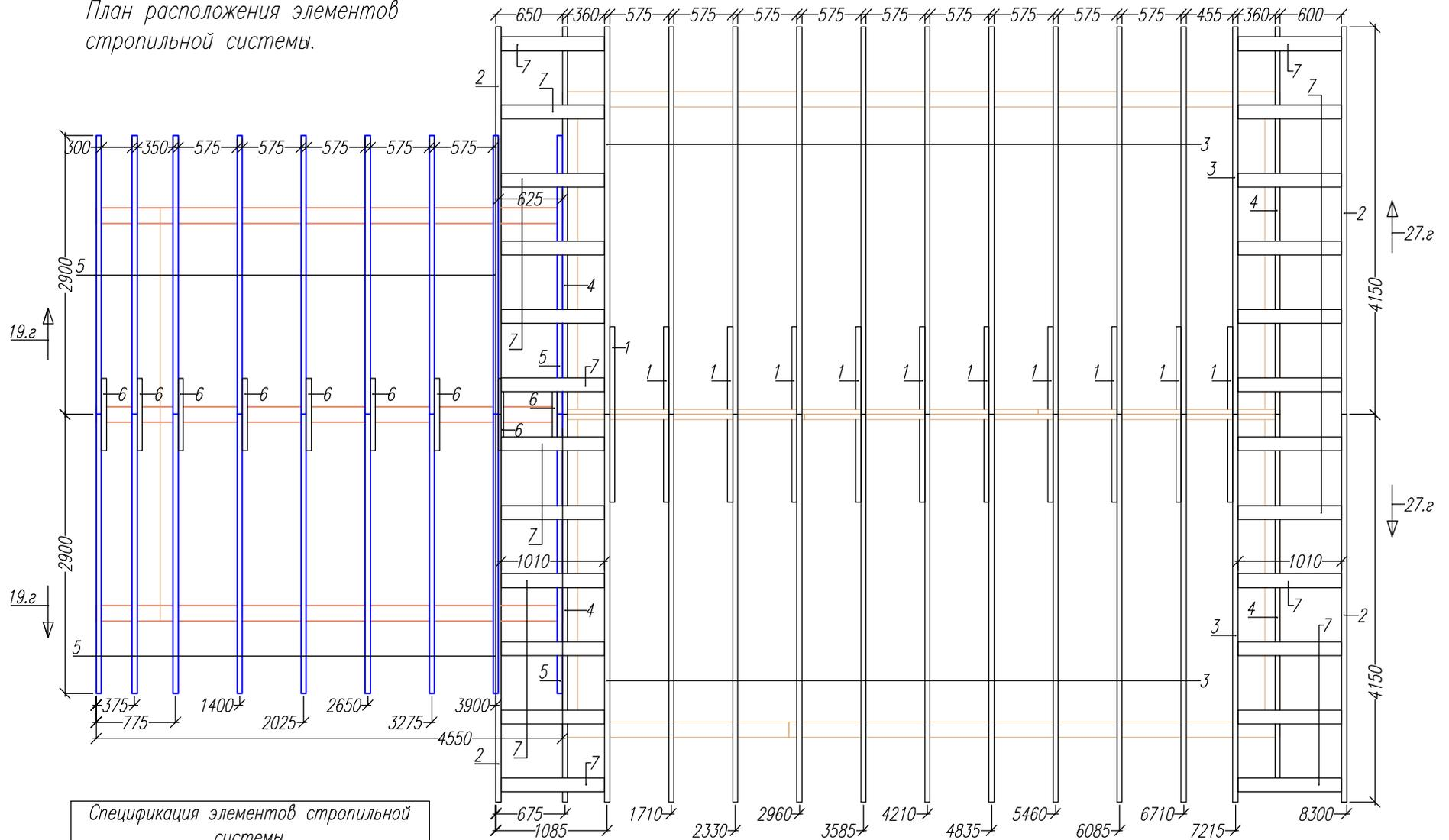
Спецификация элементов стропильной системы.
